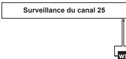
Toutes les 7 secondes, la radio surveille le dernier canal utilisé. L'alerte météo 'WX' est en fonction.
