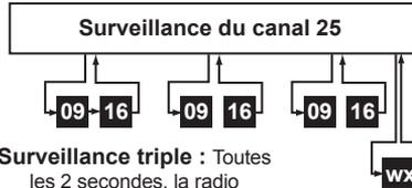
**Surveillance triple :** Toutes les 2 secondes, la radio surveille les canaux 9 et 16.
