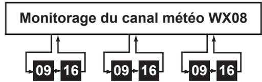
**Surveillance triple** : Toutes les 2 secondes, la radio surveille le canal 9, puis le canal 16.
