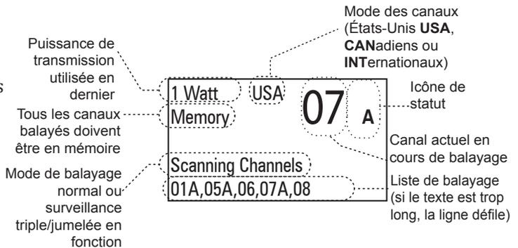
**Utiliser la radio en mode de balayage**
