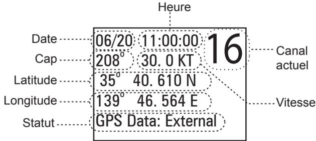
Si le GPS n'envoie pas les coordonnées à l'intérieur de trente (30) minutes, une alerte audible retentira une fois et l'écran affichera *Input Position*. Ce message demeurera affiché jusqu'à ce que les coordonnées soient mises à jour.
