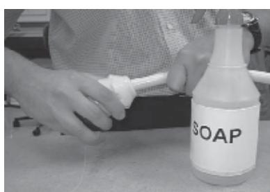
2. Appliquez une solution savonneuse sur l'extrémité de la gaine et retournez-la en poussant le câble sur l'entrée de la gaine. Enfoncez le câble sur une longueur d'environ 30 cm à travers la douille.
